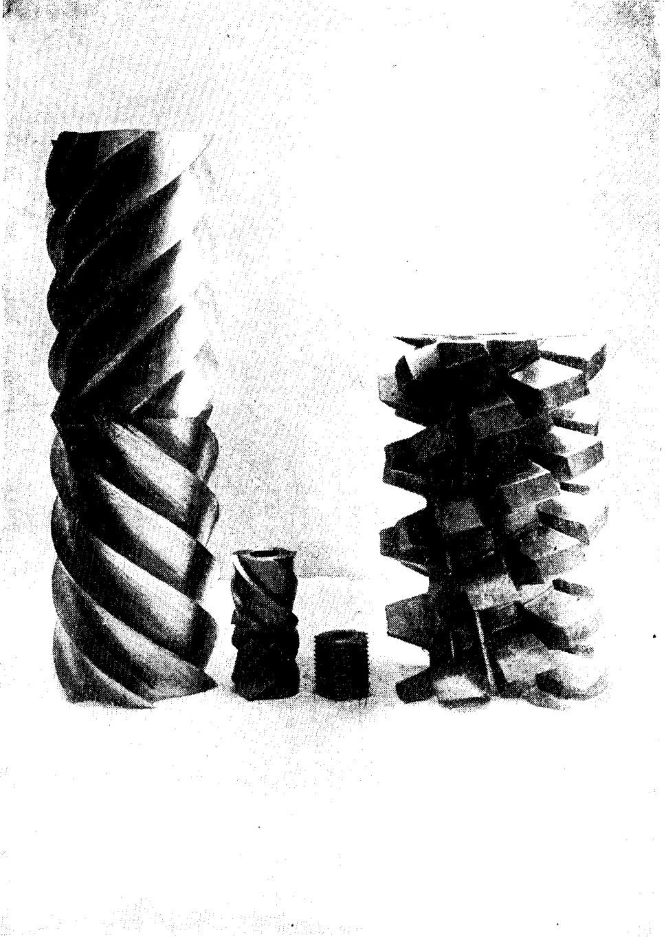
Группа высокопроизводительных фрезеров. Слева — фрезера типа Коха для обработки паровозных рам; справа червячный модульный фрезер мод. 22 для обработки деталей к экскаваторам Московского метрополитена; в центре — шлифованный резьбовой фрезер.
